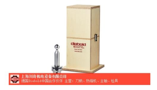
机床检验棒用于检验各种机床的几何精度,采用质量碳素工具钢制造,加工中经过多次热处理,工作面精密磨削而成。
